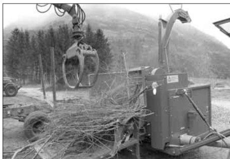
Der neue Trommelhäcksler auf der Kompostieranlage Reißeck im Einsatz.
